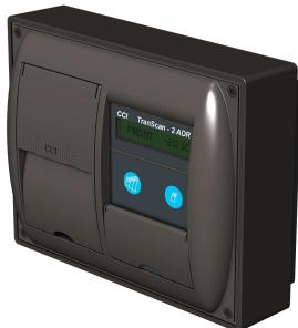
**TranScan2C** zur Installation im Fahrerhaus an eine senkrechte Fläche oder an eine Trennwand.
